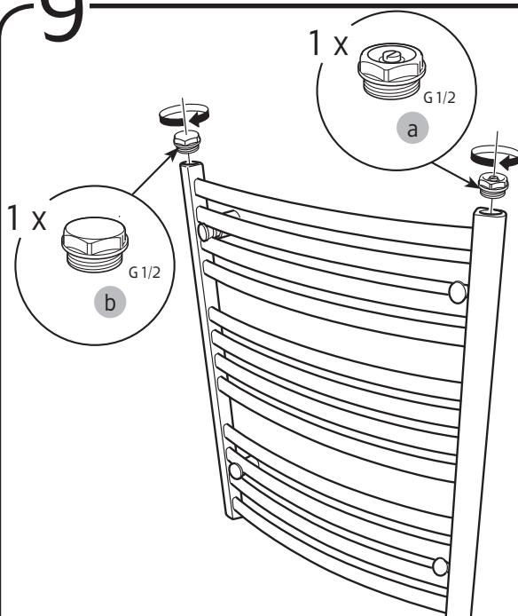
SE Pluggarna och luftningen är o-ringstätade och ingen övrig gängtätning behövs. Pluggarna och luftningen dras till de bottnar helt mot handdukstorken. Kontrollera att anslutningarna är tätta efter installation
